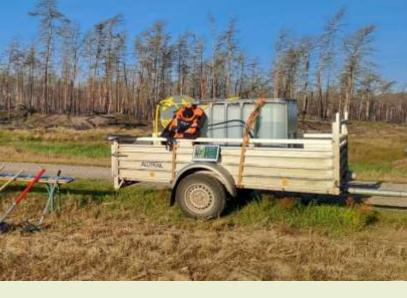
Flexibler Transport einer Pickup-Löschbox zur Unterstützung der Wasserversorgung für Waldbrandnachsorgemaßnahmen, Foto: THOR, 2023
