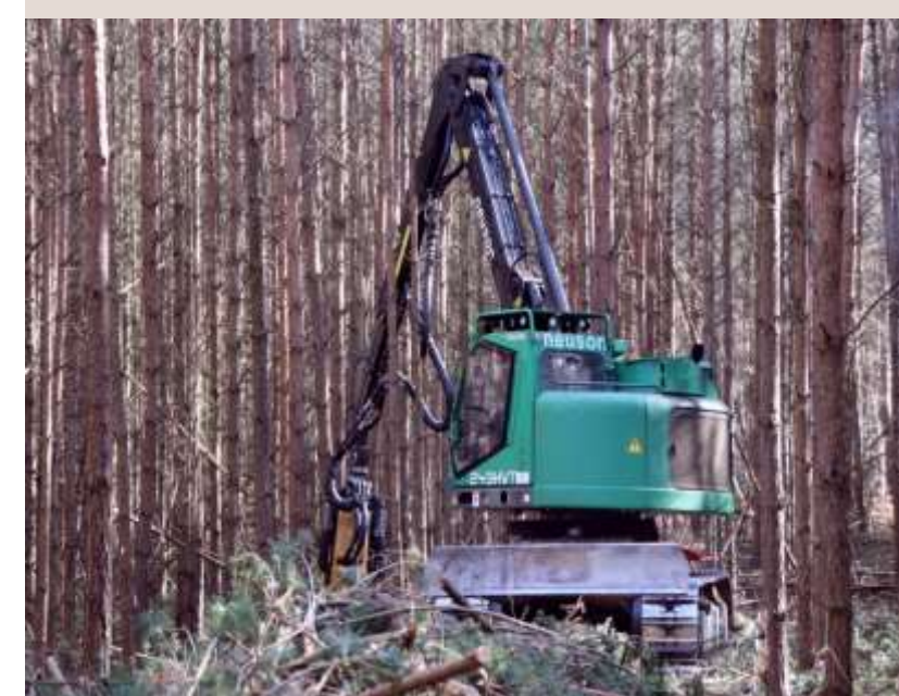
Geschützte Forsttechnik (Harvester) im Einsatz auf kampfmittelbelasteter Fläche im Forstamt Kaliß, Foto: THOR, 2022
